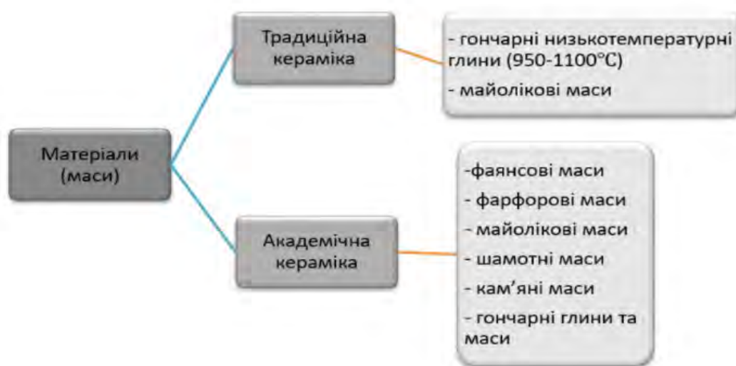
Рис. 4. Порівняння використання матеріалів (мас і глин) для виготовлення традиційної та академічної кераміки
